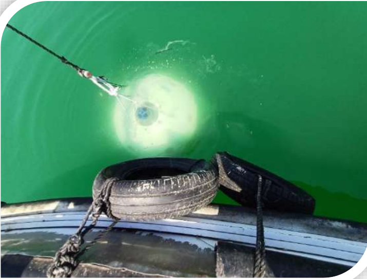
מד זרם השייך למעבדה של פרופ' ירון טולדו מאוניברסיטת תל אביב מורד לעומק הכנרת. אוגוסט 2023
