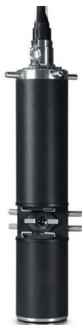
איור 72: בתמונה מכשיר מסוג פלואורופרוב (BBE Fluoroprobe) המשמש לאיסוף הנתונים במרחב הכנרת, כחלק מתכנית הניטור של הכנרת.
